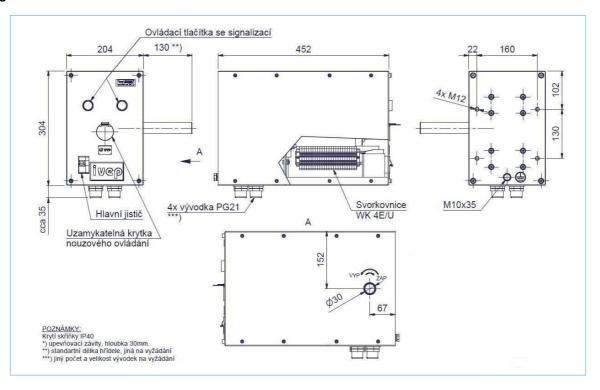
ovládací skříňka se signalizací = control cabinet with indications uzamykatelná krytka ručního ovládání = lockable cover of manual control element řadové svornice = terminal block
