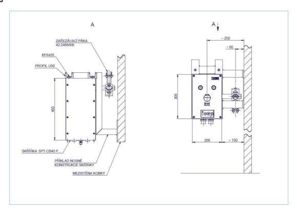
zařezávací páka = cut-in lever skříňka = cabinet příklad nosné konstrukce skříňky = example of arrangement of a supporting structure mezistěna kobky = partitioning wall of a switching cell
