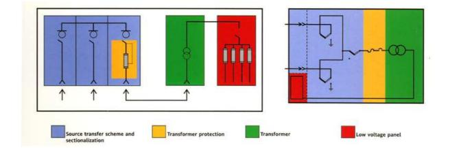
Source transfer scheme and sectionalization = schéma přenosu energie ze zdroje a dílčí dělení Transformer protection = ochrana transformátoru (ELSP Partial-Range Current = Záložní pojistky ELSP) Transformer = transformátor Low voltage panel = panel NN
